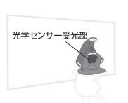
光学センサーの設置方法 図のように光学センサー受 光部をプロジェクターに向 け、光学センサーの LED が 点灯するよう前後に位置を 調整してください。
