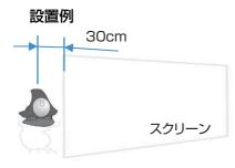
光学センサーは、プロジェクターからの直接の光が当たらない位置(投影画像の端から外側に30cmが目安)に光学センサーをスクリーンに平行にした状態でLED面がプロジェクター側を向くように設置してください。
