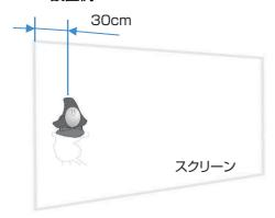
投影画像の端から 30cm を目安としてスクリーンに接触させるように LED 面がプロジェクター側を向くように設置してください。
