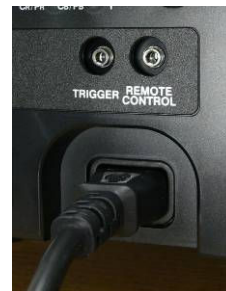
電源コード接続 拡大写真
