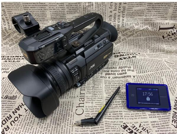
②GY-HM250BBのUSB端子に Wi-Fi / 無線LAN アダプターを取り付ける
