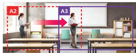
ターゲットが隣のエリアを移動したときのみ、カメラが追尾しエリアを切り替えます。
